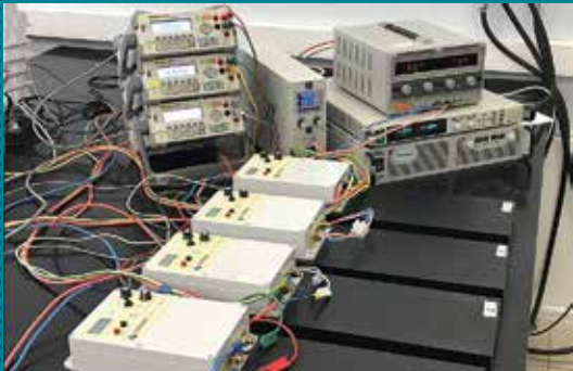
Электрические испытания электронных БСЗ
