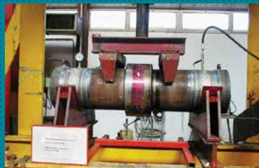
Испытания на совместное действие внутреннего давления и изгибающего момента
