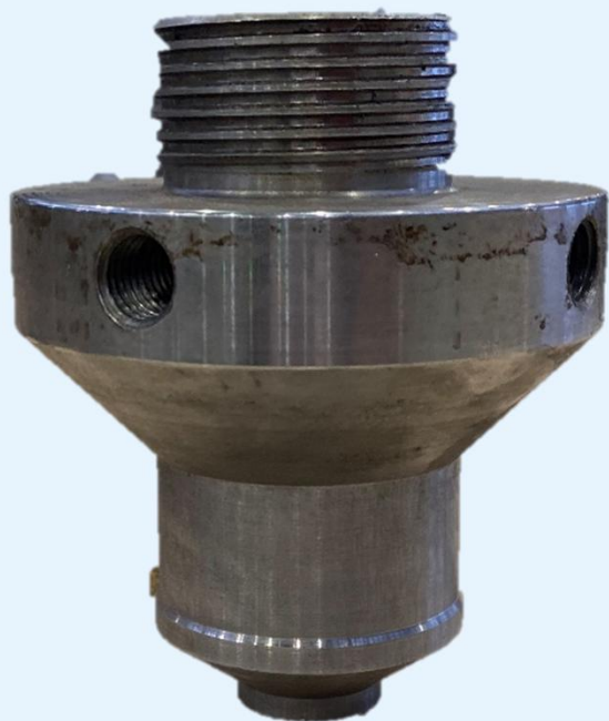
Устройство доступа под приварку
