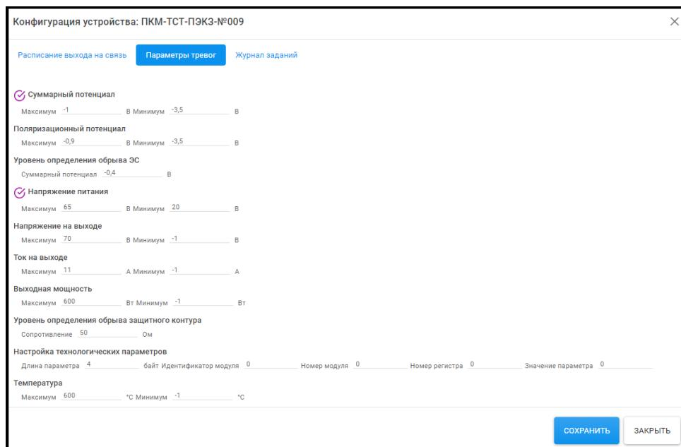
Рисунок 16 – Вид вкладки «Параметры тревог» для устройств ПЭКЗ-ТСТ
