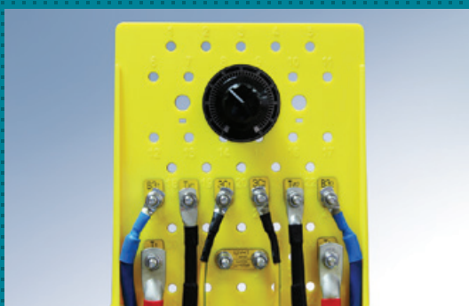
Клеммная панель с одноканальным БСЗ-10А
