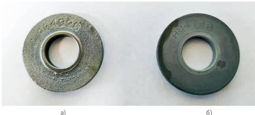
Рис. 4. Внешний вид образцов-свидетелей коррозии из стали марки 09Г2С после испытаний: а) без ингибитора (скорость коррозии – 1,19 мм/год); б) с ингибитором (скорость коррозии – 0,02 мм/год)
